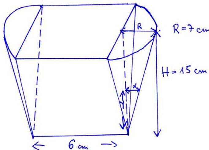
$$V_{\text{Filter}}(x,y) = V_{\text{Prisma}} + V_{\text{Kegel}} = 6A_{\text{Dreieck}} + V_{\text{Kegel}} = 6xy + \frac{1}{3} \cdot \pi \cdot x^2 \cdot y.$$
